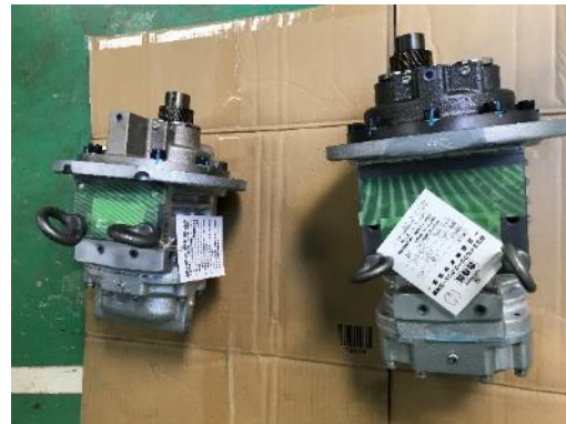
写真 2.2.7-2 圧縮機本体（リビルト品）
