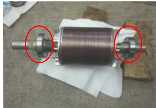
写真 2.2.13-3 ベアリング更新後
