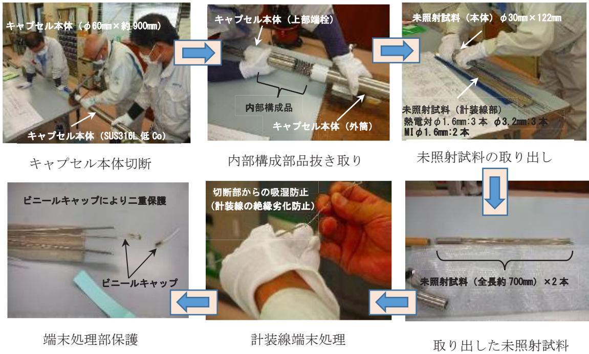
写真 2.4.1-1 資源エネルギー庁の受託キャプセルからの未照射試料取り出し作業
